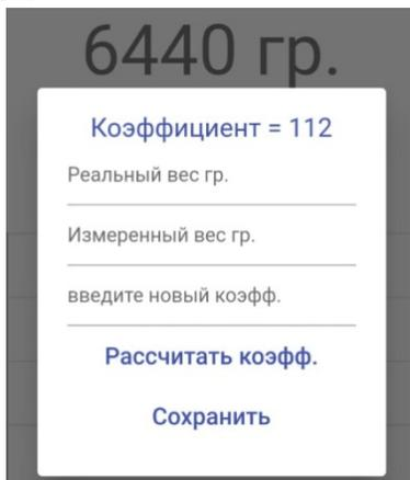
Получим сообщение, что Коэффициент установлен. Снять груз и обнулить весы.
