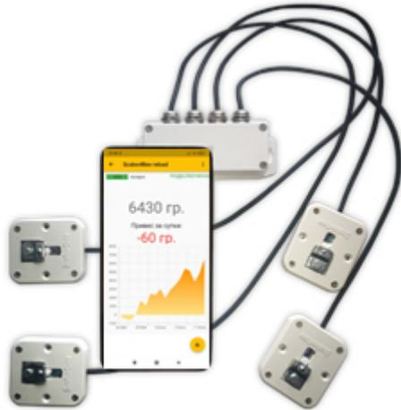
Пасечные весы Scales4Bee предназначены для контроля привесов пчелосемьи на пасеке. Управление весами происходит полностью со смартфона. Передача данных осуществляется по протоколу bluetooth low energy 4.1. Весы отображают текущий вес, производят автоматическое измерение веса, в соответствии с расписанием (Задается пользователем). Текущий вес отображается на дисплее смартфона.
